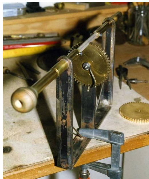
Der alte Wälzstuhl war Vorbild für die Neuanfertigung, dabei konnte der alte Rahmen wieder verwertet werden
